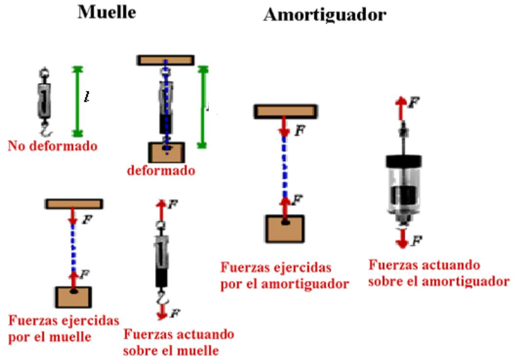
Un amortiguador es como un resorte, salvo que *ejerce fuerzas que son proporcionales a la velocidad relativa de sus dos extremos*, en lugar del desplazamiento relativo de los mismos, caso del muelle. El dispositivo es muy útil para amortiguar las vibraciones. El dispositivo está formado, normalmente, por un émbolo que empuja a un fluido, aire, aceite..., a través de un orificio pequeño - la fuerza necesaria para expulsar el líquido es aproximadamente proporcional a la velocidad del émbolo
