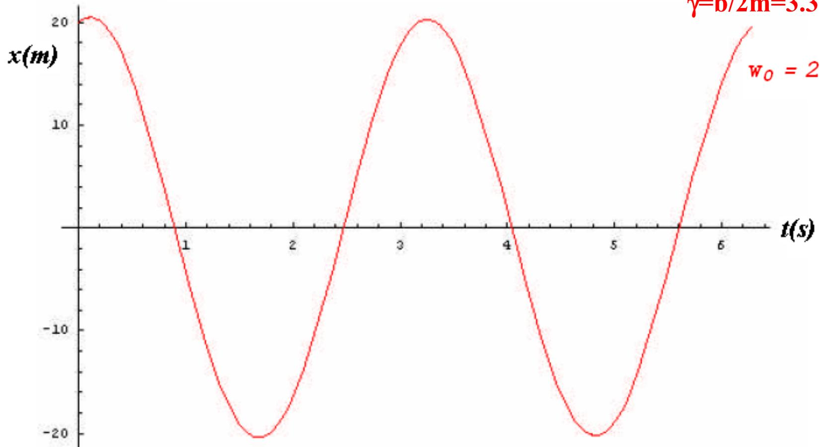
La oscilación del sistema, prácticamente no se diferencia de un *m.a.s*
