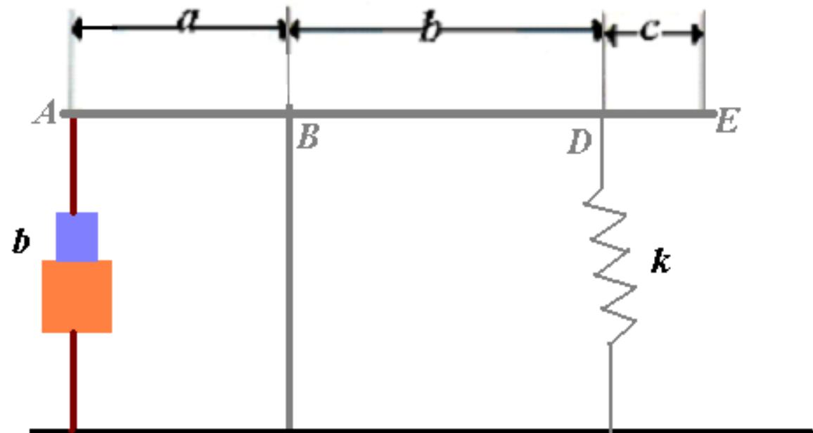
Imponemos la condición de equilibrio para la barra AE (momento de la resultante, respecto del punto B igual a cero) y se tiene, para el diagrama de sólido libre de la barra:
