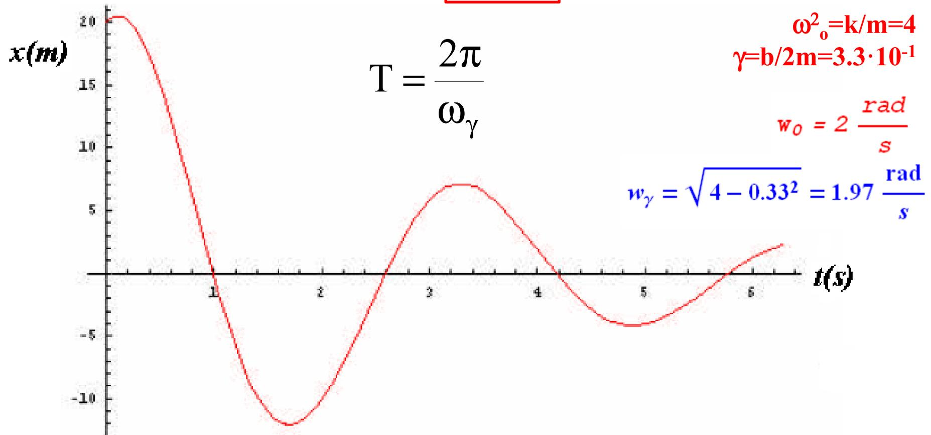
La oscilación del sistema se diferencia de un m.a.s
