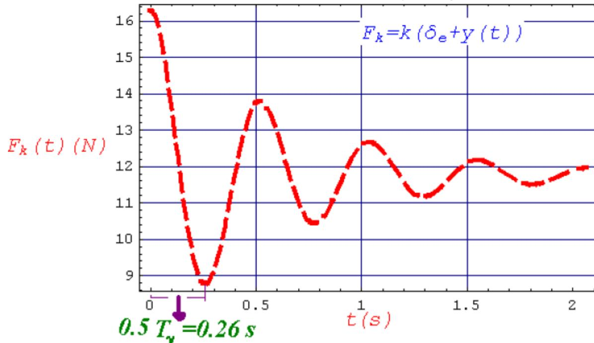
**TUTV3-10.** El cuerpo de  $20 \text{ kg}$  mostrado en la figura se desplaza una distancia de  $200 \text{ mm}$  hacia abajo desde su posición de equilibrio y se suelta desde el reposo. a) ¿Oscila el sistema? b) En caso de que oscile, definir el tipo de oscilación y dar el período. c) Obtener la posición de la masa de  $20 \text{ kg}$  en todo instante de tiempo, d) Encontrar el cociente de dos amplitudes sucesivas.
