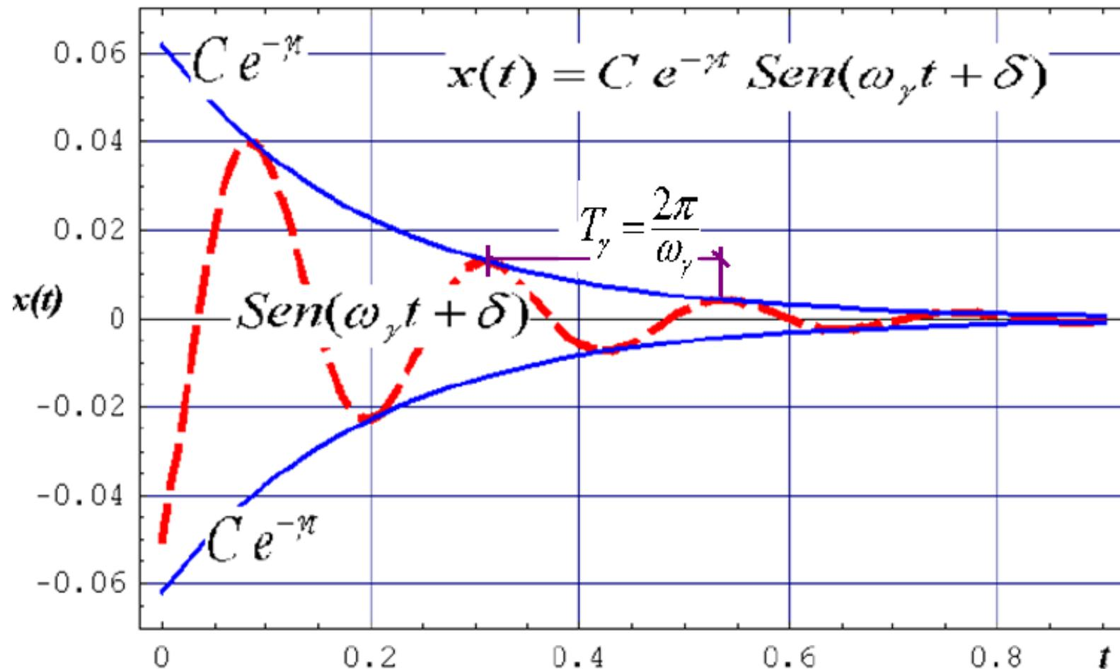
Oscilación amortiguada subcrítica. La línea a trazos, rojo, nos la la oscilación del seno con frecuencia angular  $\omega_\gamma$ , y la línea azul, nos la variación de la amplitud de la oscilación con el tiempo.
