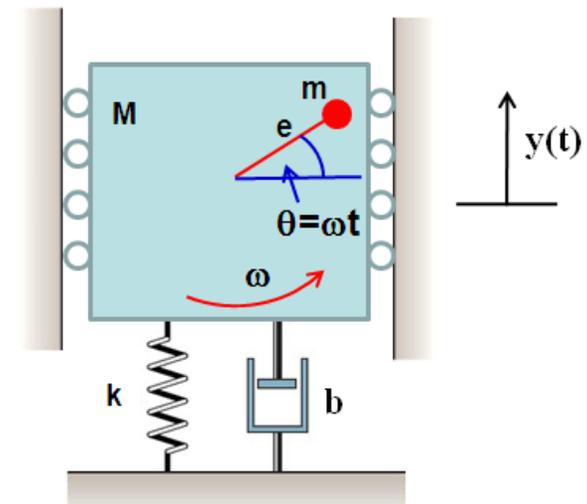
**No equilibrado** significa más masa en un lado de la máquina que en otro, una **distribución inhomogénea de masa**.
