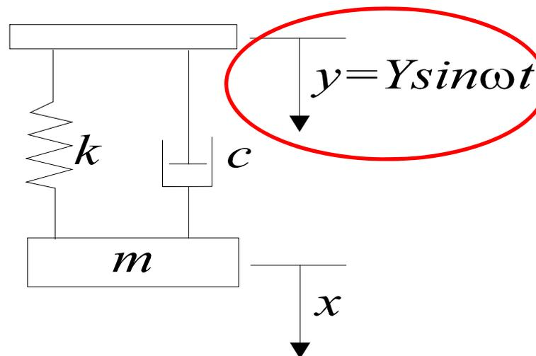
El oscilador forzado se obtiene a partir del oscilador amortiguado, introduciendo una fuerza externa armónica que actúa sobre el mismo.
