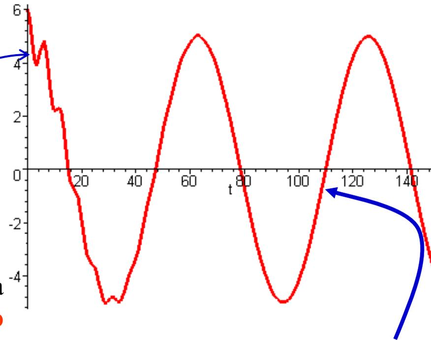
Vibraciones **transitorias** respecto de la frecuencia natural se producen en el **inicio del movimiento** (superpuestas a las vibraciones estacionarias). Las vibraciones transitorias dependen de las **condiciones iniciales** y **decaen rápidamente** si hay la más mínima pérdida de energía.
