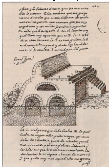
Figura 19. Sistema de construcción de un muelle. Los veintitún libros de los ingenios y máquinas. Madrid, Biblioteca Nacional de España.
