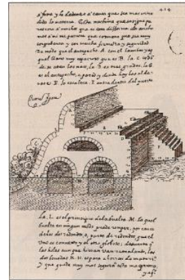
Figura 19. Sistema de construcción de un muelle. Los veintitún libros de los ingenios y máquinas. Madrid, Biblioteca Nacional de España.
