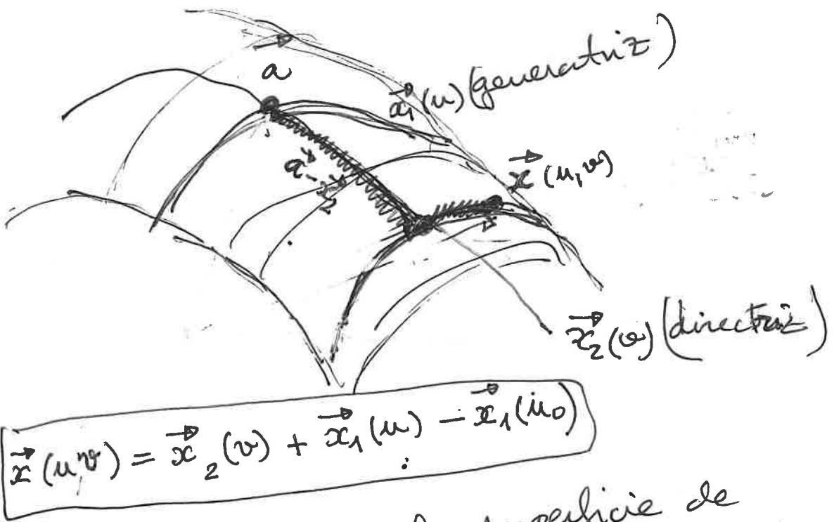
Ejemplo: Determinar la superficie de traslación que se obtiene al trasladar la recta  $\begin{cases} x=1 \\ y=0 \end{cases}$  a lo largo de la elipse
